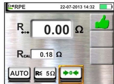
Abb. 7: Kompensation des Widerstandes von Einzelkabeln und Tastkopf
