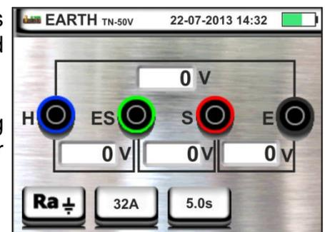
5. Berühren Sie das Symbol zur Nullstellung des Wertes im Feld "A" und stellen Sie den Wert (Bemessungsstrom wird vom EVU vorgegeben) zwischen **1A** und **9999A** mit der virtuellen Tastatur ein. Bestätigen Sie die Einstellung und kehren Sie zum Anfangsbildschirm der Messung zurück.
