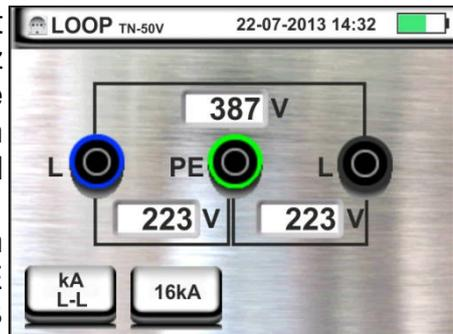
5. Drücken Sie die **GO/STOP** Taste am Messgerät oder die **START** Taste am Tastkopf. Trennen Sie während dieser gesamten Phase das Gerät nicht von dem zu testenden System.
