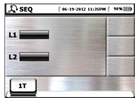
2. Bewegen Sie den Cursor der Leiste in die Stellung "1T" zur Auswahl des Tests mit einem Kabel oder in die Stellung "2T" zur Auswahl des Tests mit zwei Kabeln.
