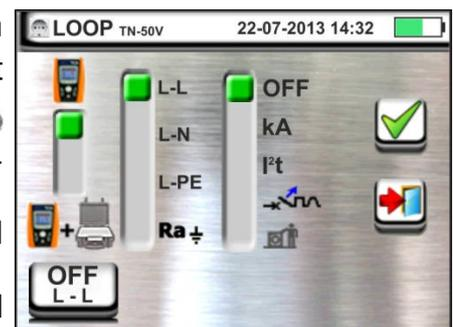
3. Trennen Sie, wenn möglich, alle dem Messpunkt nachgelagerten Verbraucher ab, denn deren Impedanz kann die Testergebnisse verfälschen.
