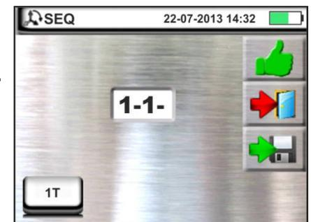
10. Ist der Testvorgang mit nicht korrekter Drehfeldrichtung beendet, zeigt das Gerät einen Bildschirm ähnlich dem hier nebenstehenden an (Ergebnis "2-1-3" => linkes Drehfeld).
