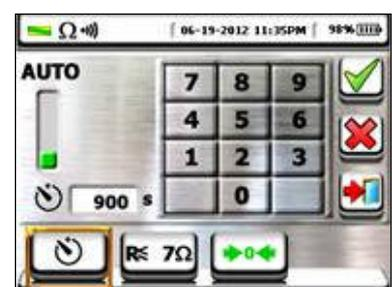
4. Berühren Sie das Symbol “ $R \leq xx\Omega$ ” zur Einstellung des maximalen Grenzwertes des Widerstandes, der das Gerät mit dem gemessenen Wert vergleicht. Der hier nebenstehende Bildschirm erscheint im Display.
