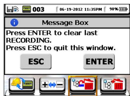
4. Berühren Sie das Symbol
