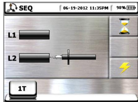
8. Ist der Testvorgang mit korrekter Drehfeldrichtung beendet, zeigt das Gerät einen Bildschirm ähnlich dem hier nebenstehenden an (Ergebnis "1-2-3", => rechtes Drehfeld).
