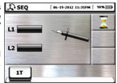
7. Das Symbol des Tastkopfes auf der Phase L2 in Zusammenhang mit der Sanduhr zeigen an, dass das Messgerät die Spannung noch ermittelt.
