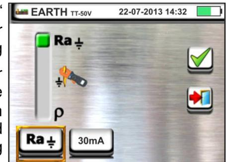
Berühren Sie das zweite Symbol unten links zur Einstellung des Auslösestromes des RCD-Schalters (TT und IT Systeme). Der folgende Bildschirm erscheint im Display:
