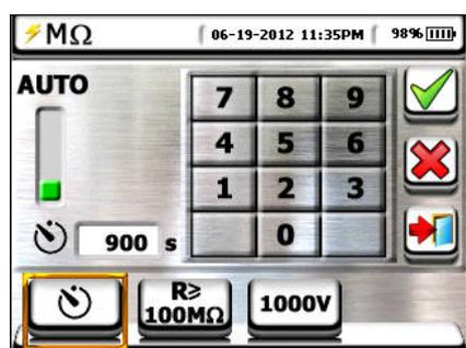
4. Berühren Sie das Symbol “ $R \geq xx\Omega$ ” zur Einstellung des minimalen Grenzwertes des Isolationswiderstandes, den das Gerät mit dem gemessenen Wert vergleicht. Der hier nebenstehende Bildschirm erscheint im Display.
