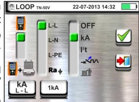
Berühren Sie das Symbol unten rechts, um den maximalen Auslösestrom einzustellen, in "kA" angegeben, den der Leistungsschutzschalter unterbrechen muss. Der folgende Bildschirm erscheint im Display:
