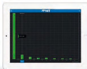
Oberwellen von Strom und Spannung
