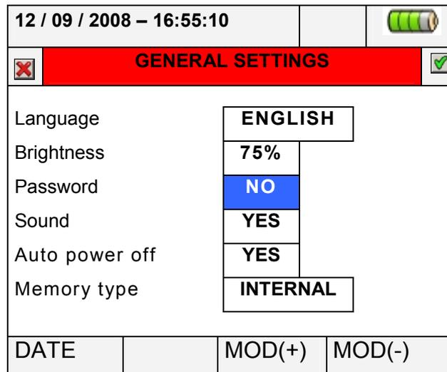
**Abb. 12: Bildschirmdarstellung des Passwortes**
