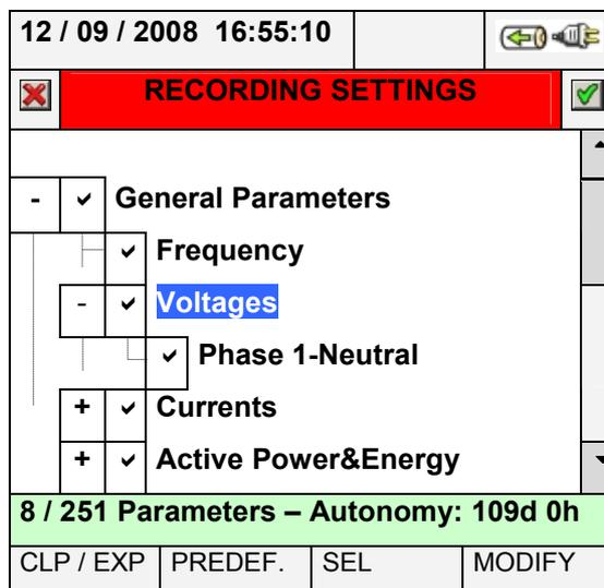
**Abb. 95: General Parameters: Untermenü – einphasiges Netz**
