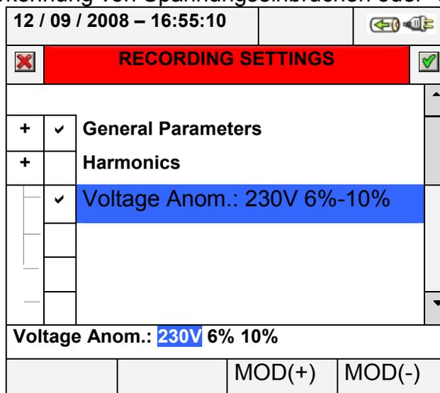
**Abb. 104: Bildschirmdarstellung Spannungsanomalien – Einstellung der Steuerparameter**
