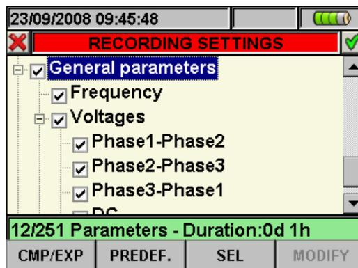
**Abb. 87: General Parameters: Untermenü – 3-phasiges PV Netz**
