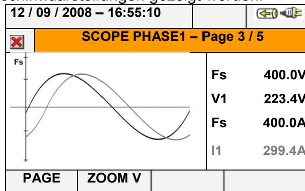
Abb. 39: Darstellung der Spannungs- / Stromkurven auf Außenleiter L1
