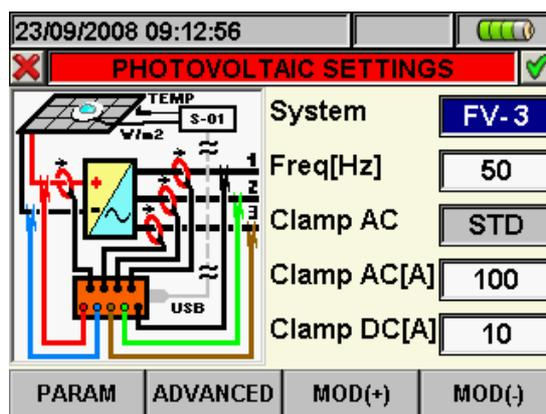
Abb. 73: Bildschirm Analysator-Konfiguration für 3 phasige PV -Netze
