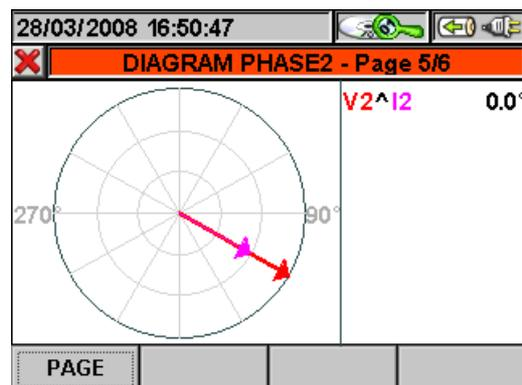
**Abb. 171:** Phase 2 Vektor Diagramm in einem Dreiphasen 4-Leiter-System
