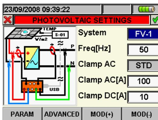
Abb. 72: Bildschirm Analysator-Konfiguration für 1 phasige PV -Netze
