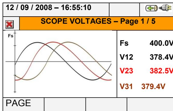
Abb. 35: Bildschirmdarstellung der Spannungskurven für Dreileiter-Netze und Aron-Schaltungen
