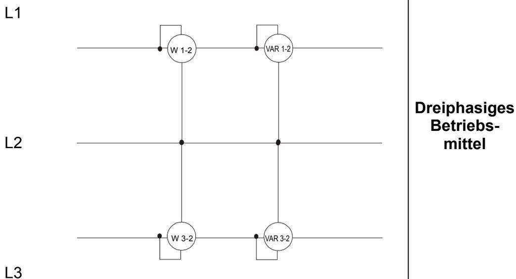
In diesem Fall wird das Potential eines der drei Außenleiter (zum Beispiel L2) als Referenzpotential angenommen. Die Gesamtwerte der Wirkleistung, Blindleistung und Scheinleistung werden ausgedrückt als jeweilige Summe der Anzeigen der Paare aus Wirk-, Blind- und Scheinleistung der beiden Messgeräte.
