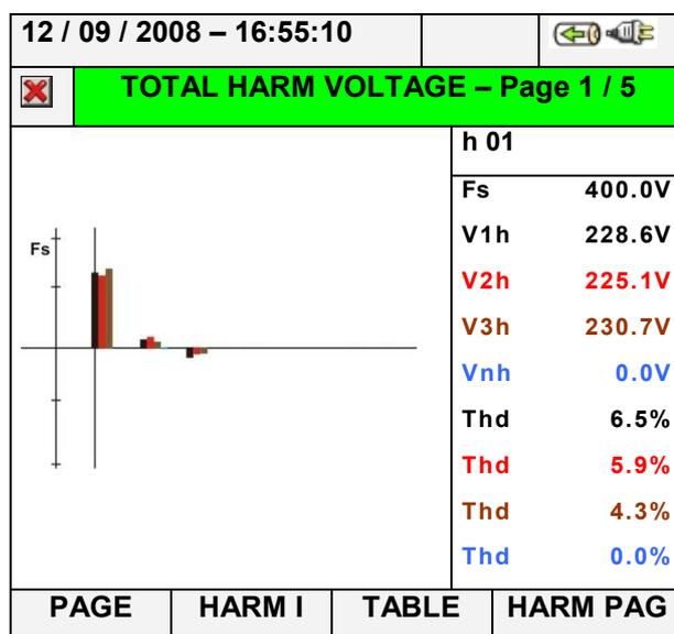
Abb. 45: Oberwellenanalyse von Spannungen in Prozent / absoluten Zahlen
