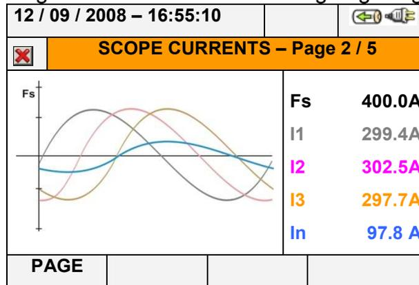
Abb. 37: Bildschirmdarstellung der Stromkurven für Vierleiter-Netze
