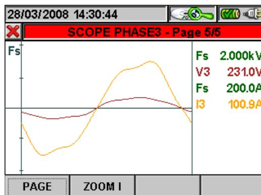
**Abb. 150** : Phase 3 Verlauf in einem Dreiphasen 4-Leiter-System
