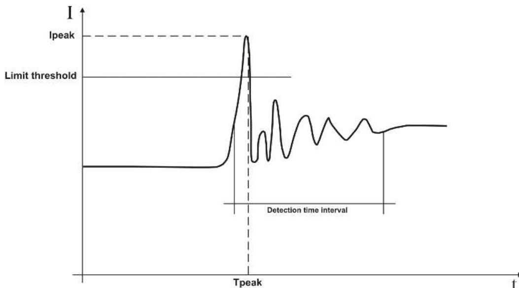
Abb. 209: Parameter eines einschwingenden Einschaltstrom-Ereignisses
