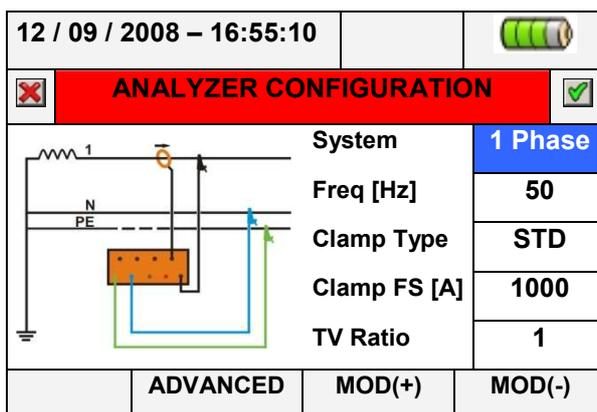
Abb. 77: Bildschirmdarstellung der Analysator-Konfiguration für einphasige Netze
