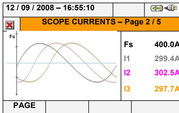
Abb. 38: Darstellung der Stromkurven für Dreileiter-Netze und Aron-Schaltungen
