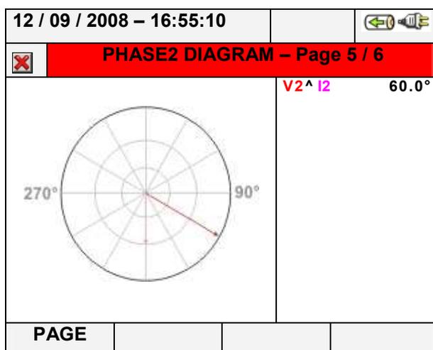
**Abb. 66: Vektordiagramm Spannung-Strom von Außenleiter L2 für Vierleiter-Netze**
