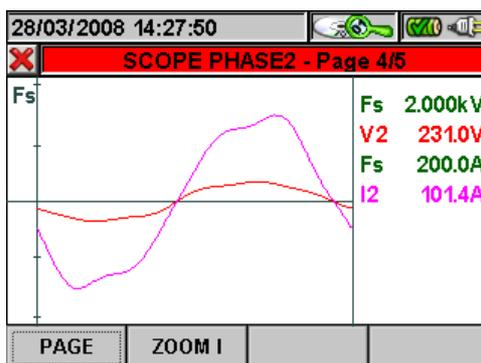
**Abb. 148** : Phase 2 Verlauf in einem Dreiphasen 4-Leiter-System
