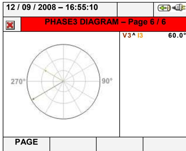
Abb. 67: Vektordiagramm Spannung-Strom von Außenleiter L3 für Vierleiter-Netze
