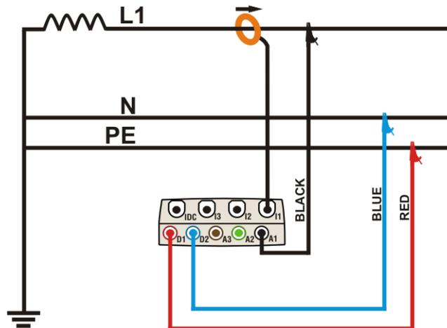
Abb. 204: Anschluss des Messgerätes an ein einphasiges Netz
