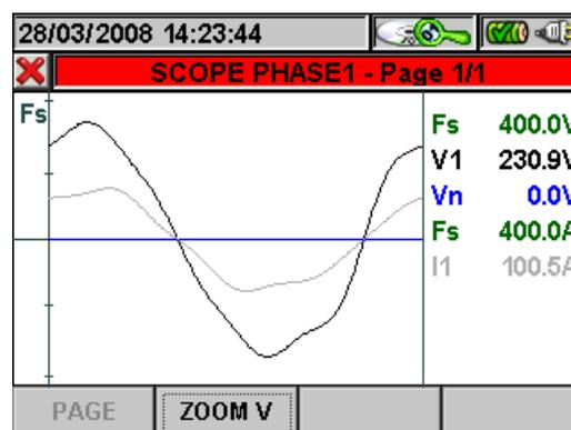
**Abb. 143 :** Spannung und Strom-Verlauf in einem EinphasenSystem
