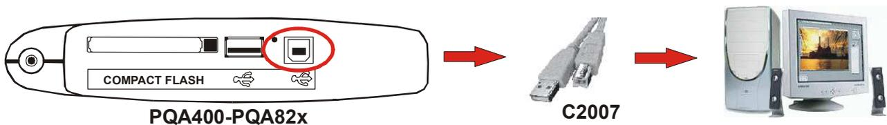
**Abb. 198: Anschluss des Messgerätes an den PC**
