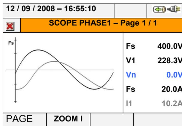
Abb. 36: Bildschirmdarstellung der Spannungs- / Stromkurven für einphasige Netze
