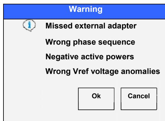
**Abb. 115: Warnmeldung: Bildschirmdarstellung der Fehler**
