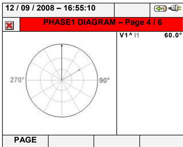
**Abb. 65: Vektordiagramm Spannung-Strom von Außenleiter L1 für Vierleiter-Netze**
