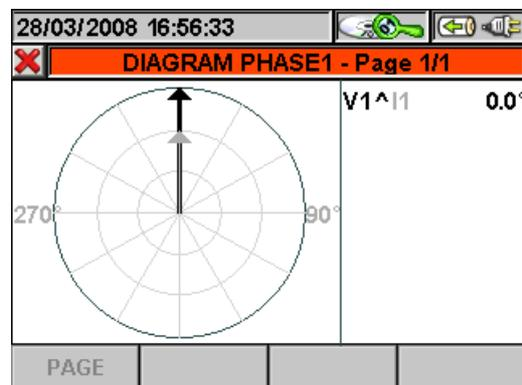
**Abb. 165:** Vektor Diagramm in einem 1-Phasen-System
