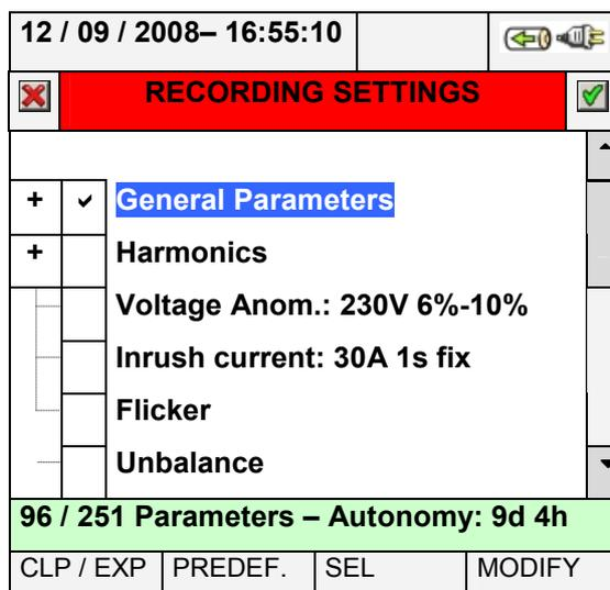
Abb. 93: Untermenü „General Parameters“: Parameter ausgewählt
