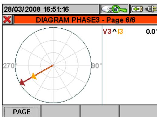
**Abb. 173:** Phase 3 Vektor Diagramm in einem Dreiphasen 4-Leiter-System
