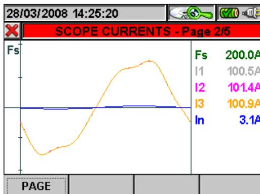
**Abb. 144** : Strom-Verlauf in einem Dreiphasen 4-Leiter-System
