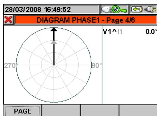
**Abb. 169:** Phase 1 Vektor Diagramm in einem Dreiphasen 4-Leiter-System
