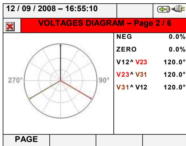
Abb. 63: Vektordiagramm der Spannung für Dreileiter-Netze und Aron-Schaltungen
