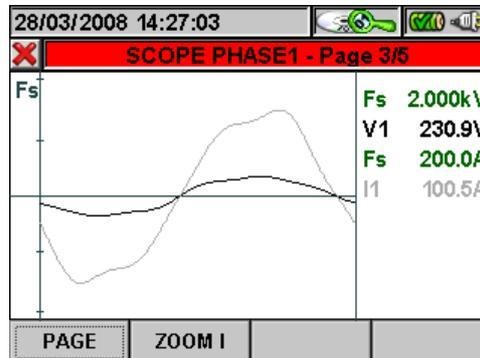
**Abb. 146** : Phase 1 Verlauf in einem Dreiphasen 4-Leiter-System
