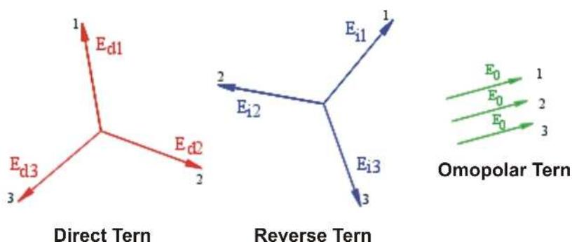
**Abb. 210: Zerlegung des eines 3er Vektorsystems**
