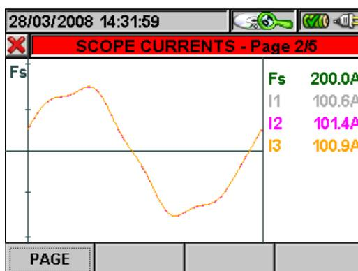
**Abb. 145** : Strom-Verlauf in einem Drei-Phasen 3-Leiter- oder Aron -System
