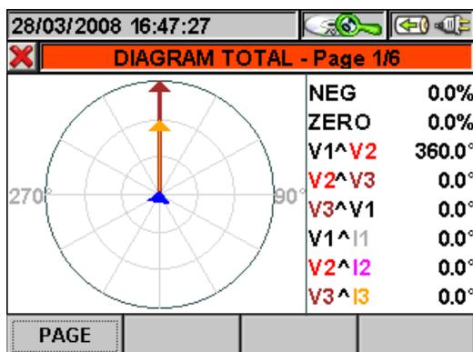
**Abb. 163:** Gesamt- Vektor Diagramm in einem Dreiphasen 4-Leiter-System
