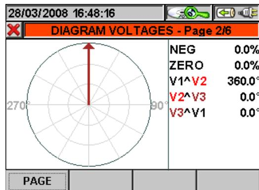
**Abb. 166:** Spannung Vektor Diagramm in einem Dreiphasen 4-Leiter-System
