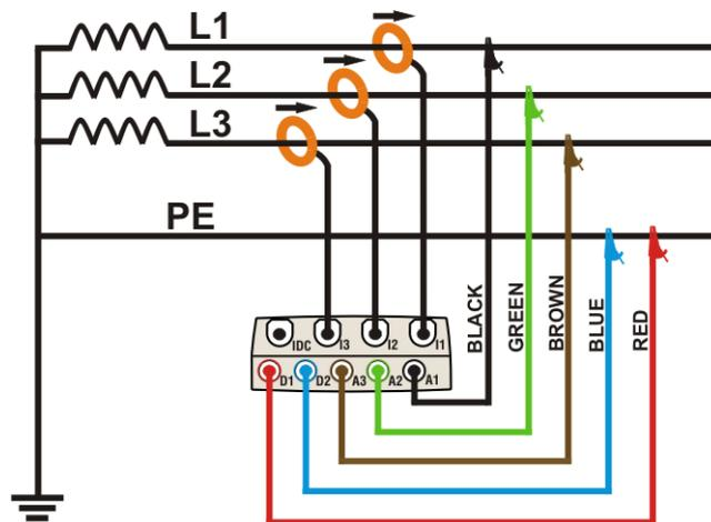
**Abb. 206: Anschluss des Messgerätes an ein Drehstrom-Dreileiter-Netz
