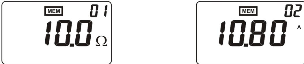
Abb. 32: Beispiele der Speicherung von einem Widerstands- oder Strommesswert
