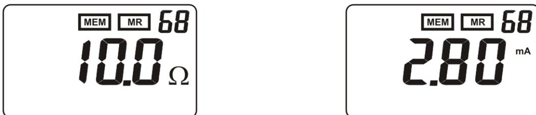
Abb. 34: Beispiele von Display-Aufruf der im Speicher gespeicherten Daten
