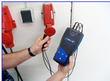
Für die Drehfeldbestimmung wird das Messgerät an den drei Außenleitern angeschlossen. Über die Phasenverschiebung zwischen den Messpunkten wird die Drehrichtung ermittelt und mit einer Leuchtdiode angezeigt. Wird fälschlicherweise der Neutraleiter oder der Schutzleiter angeschlossen, kann dies zu falschen Anzeigergebnissen führen. Der Drehfeldrichtungsanzeiger XTR0ID erkennt zuverlässig falsch angeschlossene Neutral- oder Schutzleiter und zeigt dies eindeutig an.
