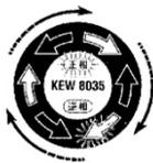
Blinkt die grüne Drehrichtungs-LED (rechts) und die Pfeilanzeigen laufen im Uhrzeigersinn so hat das angeschlossene Drehfeld eine Rechtsdrehung. Es ertönt ein Intervaltton (pi-pi-pi).
