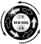
Blinkt die rote Drehrichtungs-LED (links) und die Pfeilanzeigen laufen gegen den Uhrzeigersinn, so hat das angeschlossene Drehfeld eine Linksdrehung. Es ertönt ein Dauerton (pi....)
