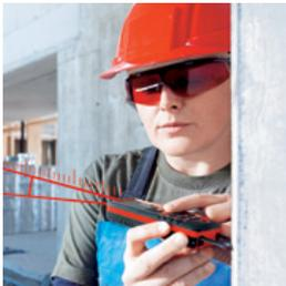
Bei Arbeiten im Außenbereich sind Laserlinien oder -punkte teilweise nicht gut erkennbar. Spezielle Lasersichtbrillen garantieren eine optimale Sichtbarkeit der Laserlinien und -punkte auch in heller Umgebung oder auf längere Distanzen. Für Anwendungen im Außenbereich empfiehlt Leica Geosystems deshalb eine Ihrer qualitativ hochwertigen Lasersichtbrillen.
