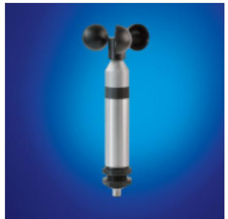
Die beheizten Windsensoren verfügen über eine thermische Entkopplung des Gehäuseschaftes, wodurch eine optimale Beheizung des Windsensor-Kopfes und minimalen Leistungsbedarf des Systems ermöglicht werden.
