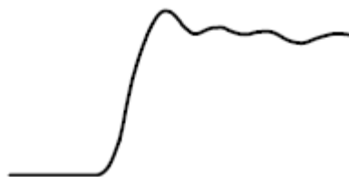
图 21: 使用接地长导线的信号
