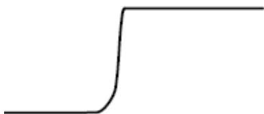
图 20: 使用接地短导线的信号
