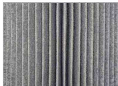
*Filterpatrone nach Abreinigung*
