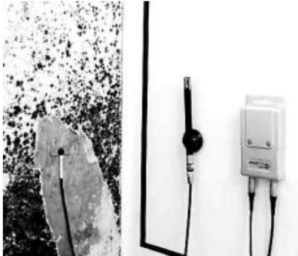
Abb. 30: Befestigung eines Plättchenfühlers
