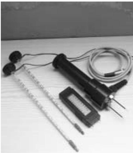
**Abb. 12: Sondentypen für Leitfähigkeitsmessung**
