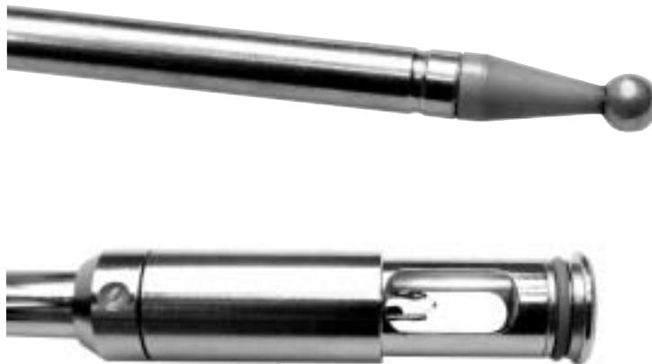
Abb.23: Hitzkugel- und Hitzdrahtbauweise
