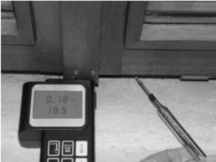
**Abb.24: Messung an einer Fensterfuge**
