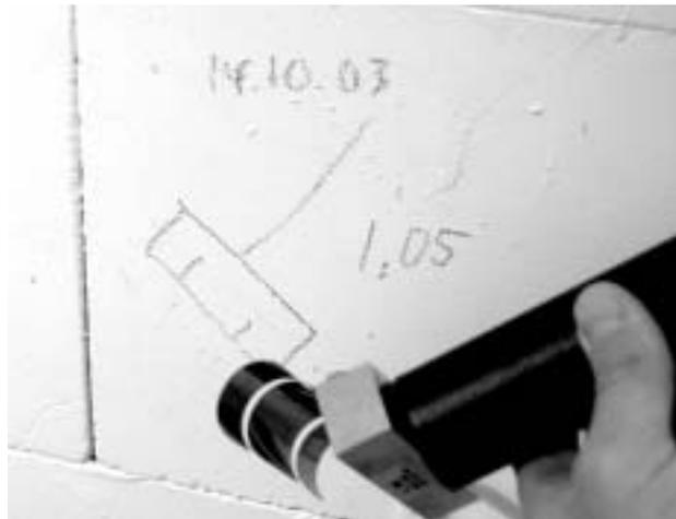
**Abb. 11: Markierung ermöglicht die Wiederholungsmessung**
