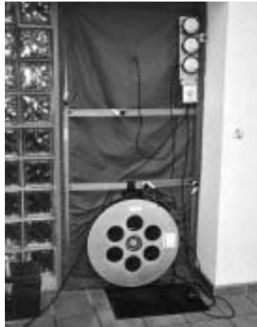
**Abb. 21: BlowerDoor eingebaut**
