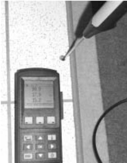
**Abb. 20: Messung in Probebohrung eines Fliesenbodens**
