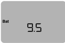
Die Batteriespannung wird beim Einschalten des Gerätes, nach dem Funktionstest, angezeigt, und kann somit jederzeit überprüft werden.
