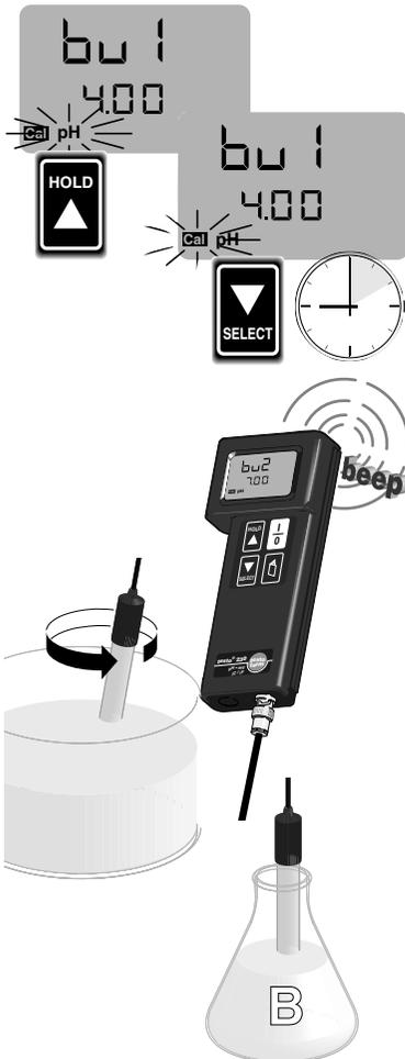
Nun wird der erste Puffer abgefragt. Mit der **Pfeiltaste** (▲) den vorgesehenen Puffer auswählen und mit **SELECT** den Abgleichvorgang starten.
