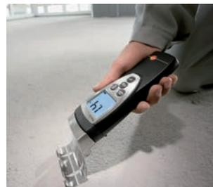
testo 616 misst zerstörungsfrei die Materialfeuchte per Kontaktfühler von Holz, Estrich, Zement und Beton in einer Tiefe von bis zu 5 cm. Das Gerät erleichtert jedem die Arbeit, der Trocknungsverläufe von Böden, Wänden und Oberflächen sowie Feuchteschäden beurteilen und beobachten muss.
