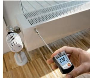
testo 905-T2 liegt auch an rauen Oberflächen perfekt an und erzielt eine hohe Messgenauigkeit. So kann rasch die Temperatur an der Oberfläche einer Wand, einer Heizung, an Ventilen oder Verbindungsteilen an Heizungsanlagen gemessen werden.
