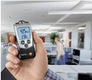
testo 610 ist sehr klein und handlich und kann dadurch jederzeit bequem mitgeführt werden. testo 610 wird einfach in den Raum gehalten und ermittelt auf Knopfdruck zuverlässig und sehr präzise die Luftfeuchte, Temperatur und Taupunkt.
