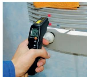
testo 830 misst per Infrarot-Technologie die Oberflächentemperatur an Wänden, Decken und Böden. So können gezielt zu kalte Stellen, an denen sich Feuchtigkeit niederschlagen könnte, ermittelt und ggf. Gegenmaßnahmen eingeleitet werden.
