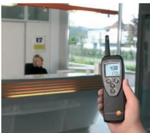
testo 625 misst Luftfeuchte, Temperatur und Taupunkt. An schlecht zugänglichen Stellen, z.B. Ecken in Deckenhöhe, können die Messwerte kabellos über große Entfernung per Funkmodul zum Messgerät übertragen werden.
