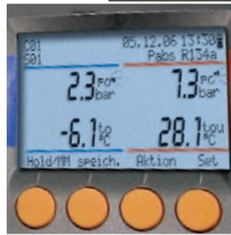
Großes, beleuchtetes Display und einfache Bedienung durch Menütasten
