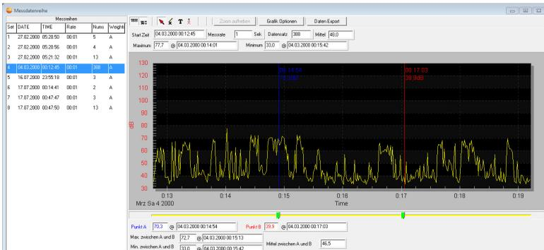
In der linken Hälfte werden die im Gerätespeicher vorhandenen Messreihen angezeigt und können per Mausklick ausgewählt werden.
